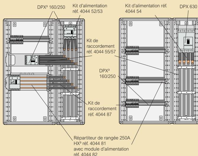
Les répartiteurs de rangée alimentés par jeux de barres latérales doivent être équipés du module d'alimentation réf. 4044 82/85
