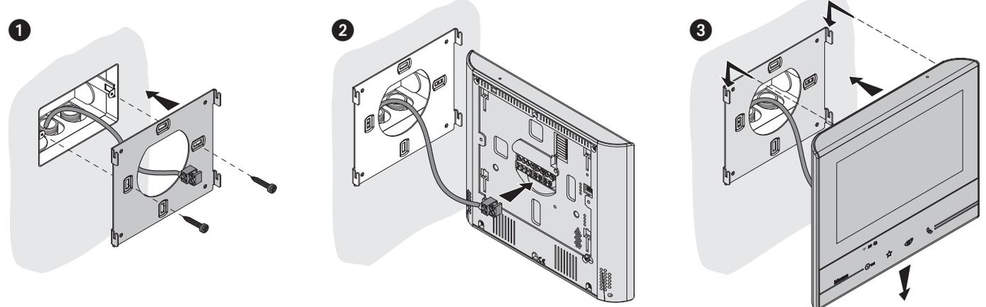
**Attenzione:** evitare di fissare la staffa su superfici non piane o irregolari e di effettuare un eccessivo serraggio delle viti, al fine di evitare deformazioni della staffa che potrebbero compromettere la corretta installazione del dispositivo. Il dispositivo deve scorrere nelle apposite guide della staffa con una leggera pressione e senza sforzo eccessivo
