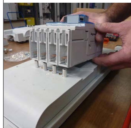
Mettre en place de l'appareil sur la partie mobile de la base.
