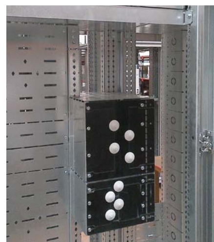
L'utilisation des caissons de cloisonnement pour les raccordements aval en IS 233/333 permet d'obtenir le niveau de forme 4b.
