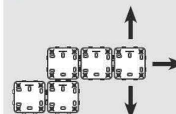
Die Bodenplatten werden über ein mitgeliefertes Verbindungsstück zu Mehrfachkombinationen beliebiger Grösse montiert.
